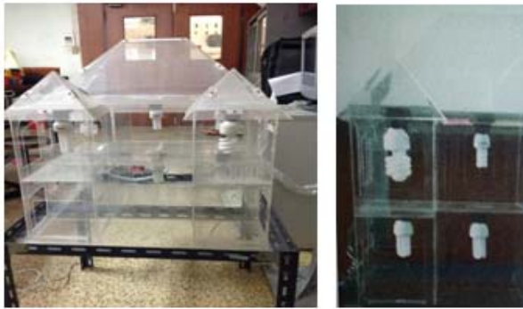
ภาพที่ 7 การประกอบบ้านจำลองสำหรับติดตั้งหลอดไฟฟ้า
