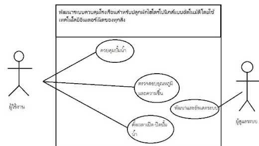
ภาพที่ 1 ยูสเคสการใช้งานระบบควบคุมโรงเรือนสำหรับปลูกผักไฮโดรโปนิคส์แบบอัตโนมัติโดยใช้เทคโนโลยีอินเทอร์เน็ตของทุกสิ่ง
