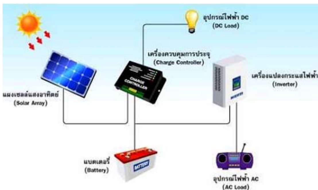
รูปที่ 3 การทดลองการใช้งานไฟฟ้าจากแบตเตอรี่ 12V /125 Ah โดยผ่าน Inverter
